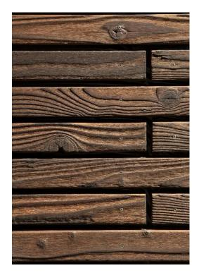
BU: Im Blickpunkt – markante Strukturen: Die besonders breiten Jahresringe und auffälligen Äste der Douglasie werden durch eine Karbonisierung noch ausdrucksvoller.
